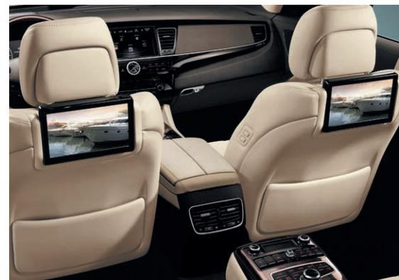
**Задняя панель управления в подлокотнике** Широкие кнопки и клавиши, удобно расположенные в подлокотнике заднего сиденья, позволяют пассажирам управлять функциями развлекательной мультимедиа-системы, вторым рядом климат-контроля, вентиляцией сидений и задней шторкой.
