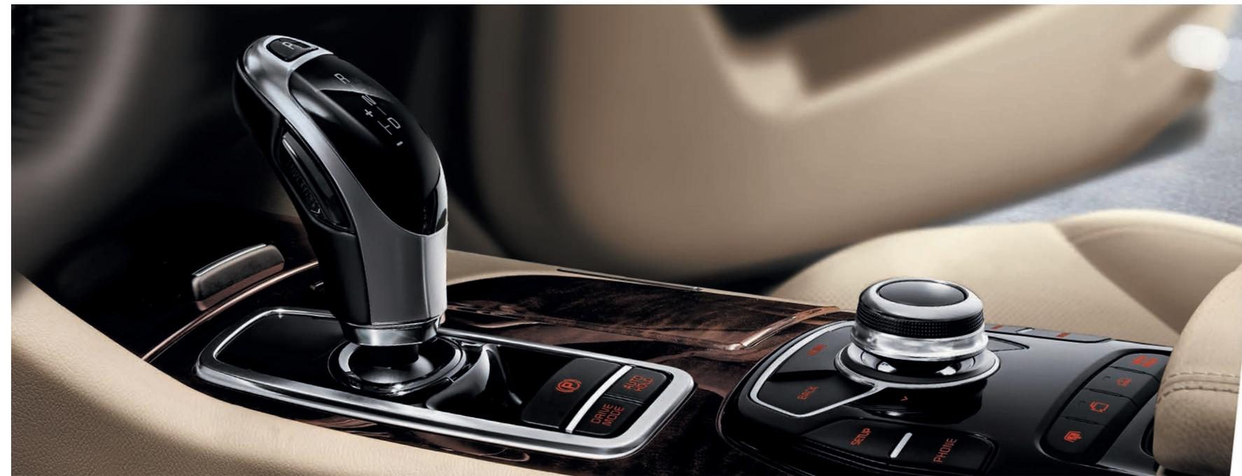
**Джойстик коробки передач SBW (Shift-By-Wire)** KIA Quoris представляет инновационную технологию SBW (Shift-By-Wire), которая обеспечивает отсутствие механической связи между переключателем и коробкой передач. Чувствительный рычаг управления, обеспечивающий быстрое и плавное переключение передач, и использование технологии SBW экономит пространство и уменьшают вес автомобиля, а также понижают уровень шума от двигателя в салоне.
