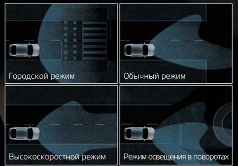
**Светодиодные фары ближнего и дальнего освещения и система адаптивного освещения (AFLS)** Система обеспечивает оптимальную видимость в ночное время, AFLS регулирует интенсивность светового потока в зависимости от скорости движения машины и угла поворота руля.
