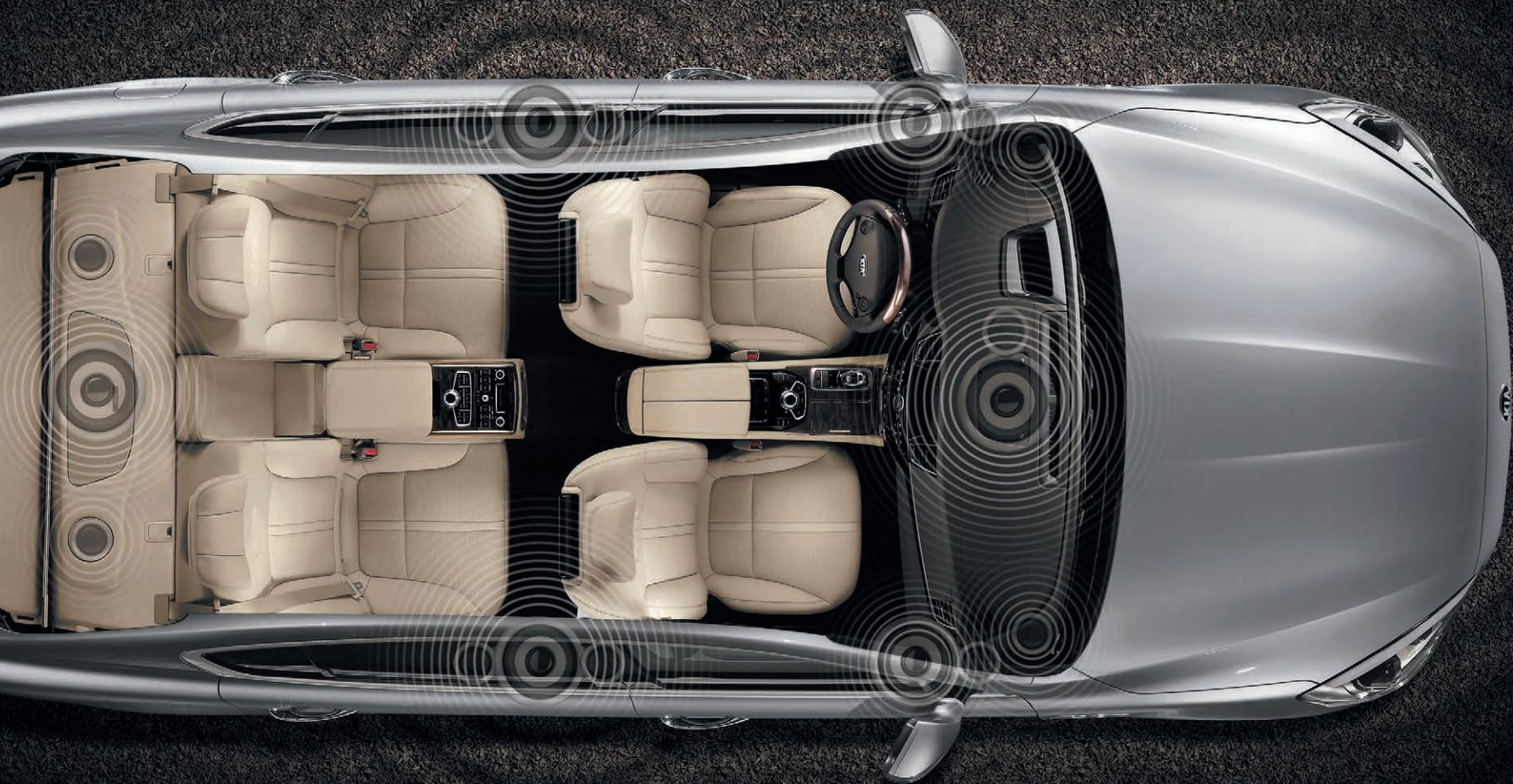
**Аудиосистема премиум-класса** Аудиосистема Lexicon от Harman славится поистине симфоническими стандартами аудиовоспроизведения. Звучковая система KIA Quoris включает 17 динамиков и 12-канальный цифровой усилитель. Технология акустических линз обеспечивает равномерное звучание по всему салону, а сабвуфер воспроизводит низкие частоты, придавая музыке глубину.
