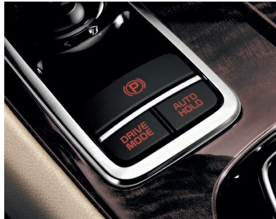
**Функция Autohold** предотвращает скатывание автомобиля. Больше не нужно держать ногу на педали тормоза, удерживая машину от скатывания, когда Вы едете по склону или медленно движетесь в пробке.
