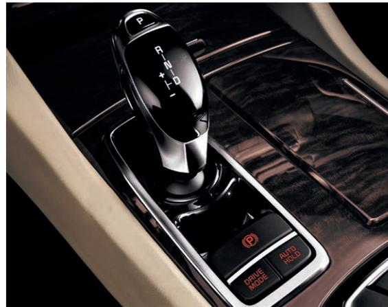
**8-ступенчатая автоматическая трансмиссия KIA** Обновленная 8-ступенчатая автоматическая коробка передач гарантирует моментальное ускорение и улучшает топливную экономичность. Выбор из четырех полностью автоматических режимов (Eco, Normal, Sport и Snow) обеспечивает идеальные характеристики для всех условий вождения.
