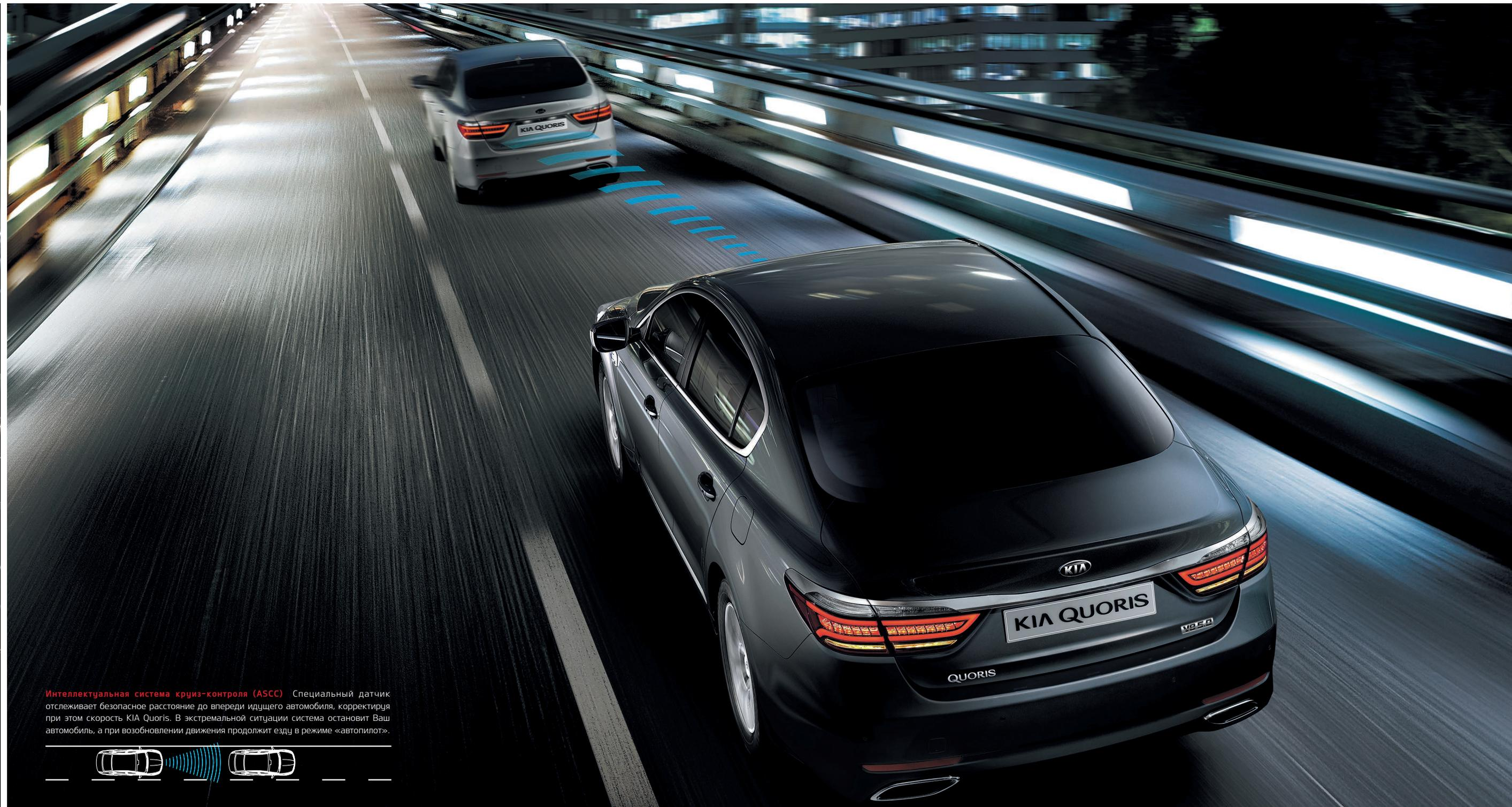
**Интеллектуальная система круиз-контроля (ASCC)** Специальный датчик отслеживает безопасное расстояние до впереди идущего автомобиля, корректируя при этом скорость KIA Quoris. В экстремальной ситуации система остановит Ваш автомобиль, а при возобновлении движения продолжит езду в режиме «автопилот».
