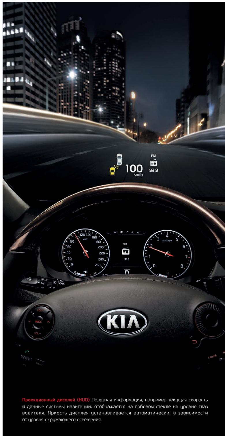
**Проекционный дисплей (HUD)** Полезная информация, например текущая скорость и данные системы навигации, отображается на лобовом стекле на уровне глаз водителя. Яркость дисплея устанавливается автоматически, в зависимости от уровня окружающего освещения.
