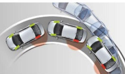
Подтормаживание задним левым колесом для удержания автомобиля на траектории.
